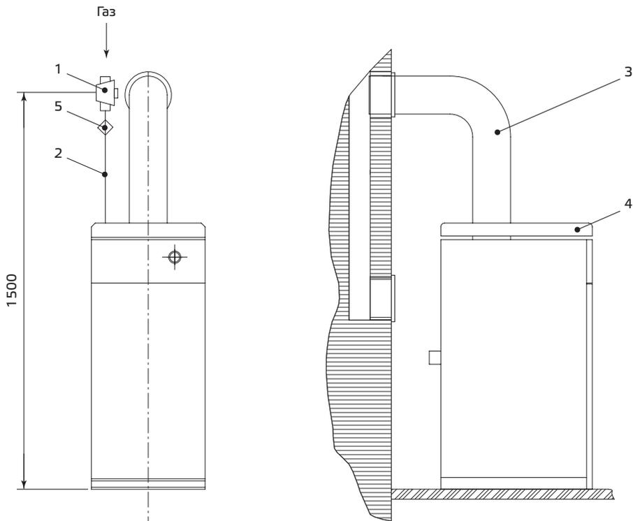
1 — газовый кран; 2 — газоподводящая труба;
