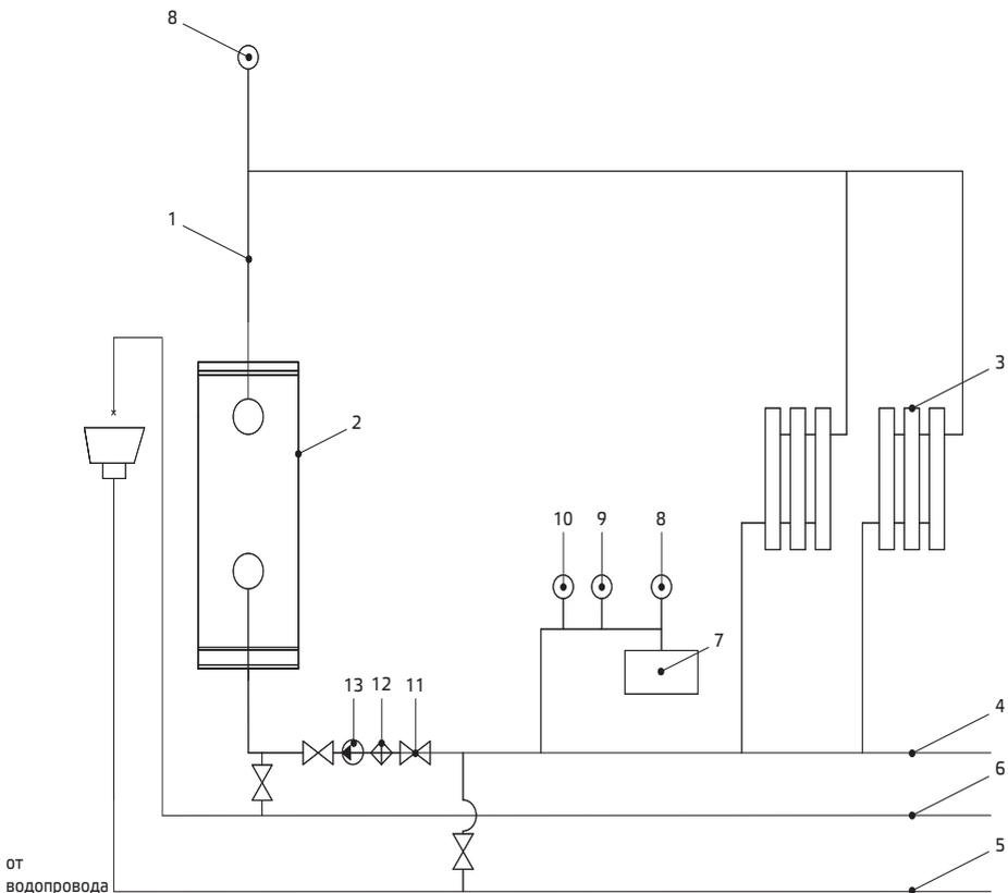
1 — главный стояк; 2 — аппарат; 3 — радиатор; 4 — трубопровод обратной воды; 5 — сливная магистраль; 6 — подпиточный водопровод; 7 — мембранный расширительный бак; 8 — автоматический клапан выпуска воздуха; 9 — манометр; 10 — предохранительный клапан 150 кПа (1,5 кгс/см<sup>2</sup>); 11 — кран; 12 — фильтр; 13 — насос
