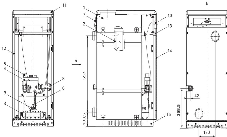
1 — газоотводящее; 2 — теплообменник; 3 — горелка основная; 4 — газовый клапан; 5 — пьезорозжиг; 6 — термopapa; 7 — датчик тяги; 8 — термopрерыватель; 9 — запальная горелка (пилотная); 10 — термометр; 11 — крышка; 12 — стенка боковая левая/правая; 13 — панель; 14 — стенка передняя; 15 — рама
