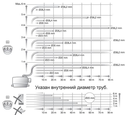
Рис. 48 Максимальная длина вертикальных и горизонтальных сливных труб
