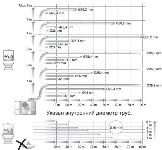
Рис. 45 Максимальная длина вертикальных и горизонтальных сливных труб
