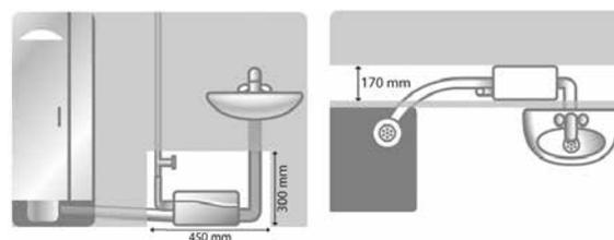
Рис. 42 Для раковины и душевой кабины (Sololift2 D-2)
