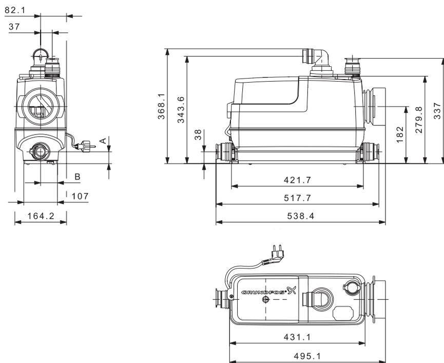
Рис. 53 Габаритные размеры, Sololift2 CWC-3
