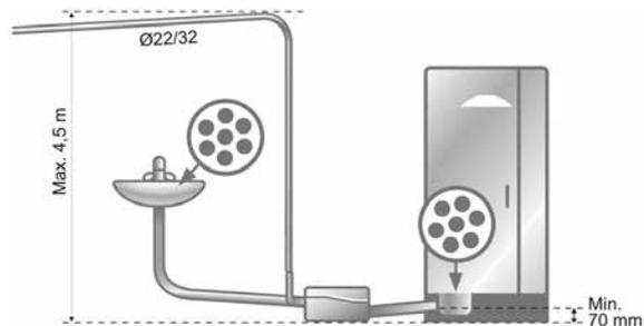
Рис. 41 Для раковины и душевой кабины (Sololift2 D-2)
