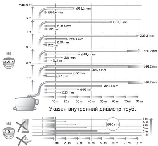
Рис. 51 Максимальная длина вертикальных и горизонтальных сливных труб
