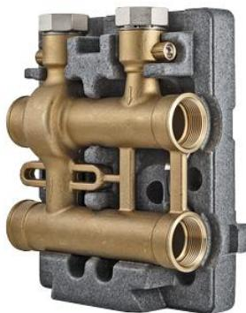
К коллекторному модулю VAR 30 системы VARIMIX присоединяются насосные и насосно-смесительные модули отопительных контуров (VAR 10,11,20,21,22). К каждому модулю присоединяется один отопительный контур. Коллекторные модули могут объединяться в последовательные блоки с помощью соединителей VT. 606.
